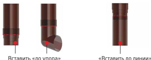
После установки труб системы водоотводения в принимающие фитинги, установите промежуточные хомуты на основания и затяните все хомуты системы водоотводения до упора.
