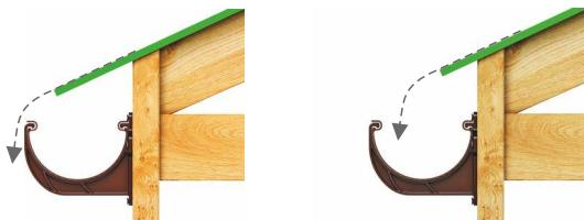
2. Свес крыши должен быть выдвинут не менее, чем на 30 мм, и не более, чем на 70 мм от края лобовой доски. При этом, чем круче уклон крыши, тем больше должен быть отступ свеса от лобовой доски.
