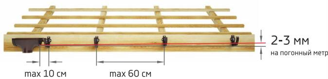
Для установки системы водосбора на металлические кронштейны необходимо нанести на них разметку линии уклона и с помощью пологиба согнуть их в нужном положении.
